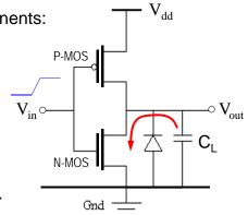
$$P_{sw} \propto C_L \cdot f \cdot V_{dd}^2$$
